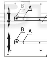
**Регулировка направляющих по высоте:**
