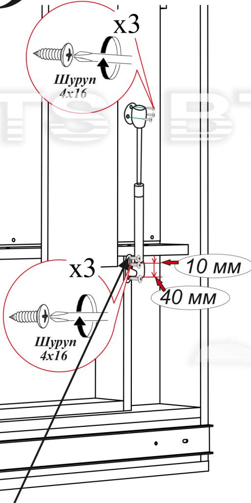
Вкрутить дополнительный шуруп 4x16 в верхнее положение для фиксации.
