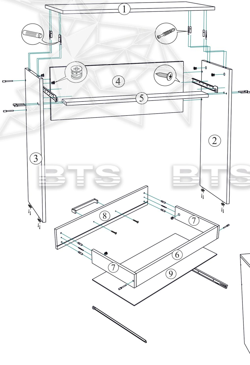
Для правильного открывания ящиков, необходимо выровнять диагонали каркаса ящика (Рис.1) и только потом прибить ЛДВП не нарушая диагонали.
